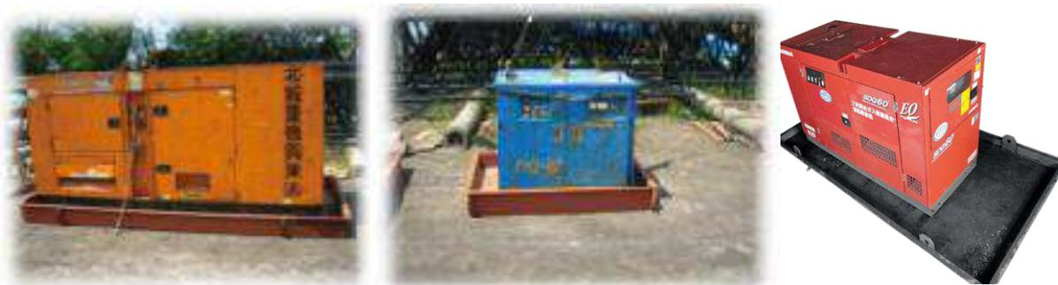
建設機械からの油漏れを防ぐ（防油堤設置事例写真参考）
